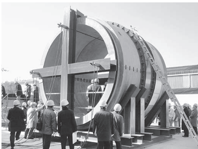
写真-3 外水圧による水密性実験
