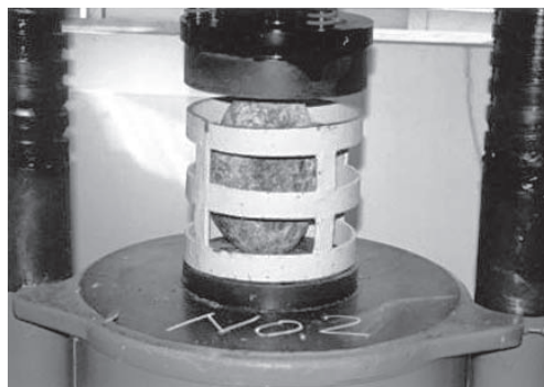
玉石の割裂試験縦割り加圧前
