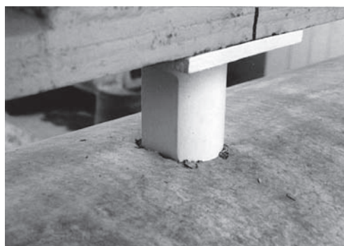
鋼製加圧ブロック貫入
