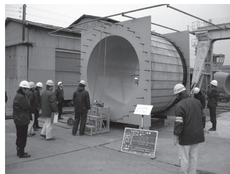
写真-6 SSP3種(6P)φ2800×2430L内圧試験状況
