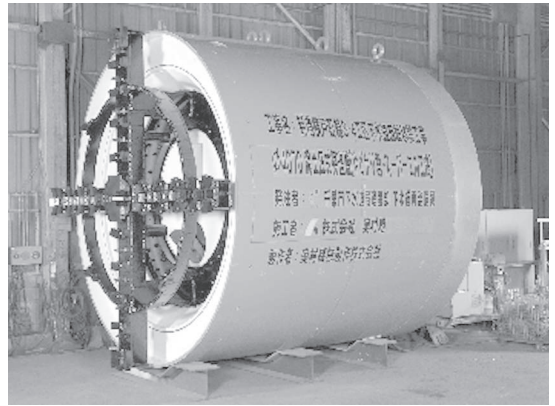
写真－1 分割回収型掘進機
