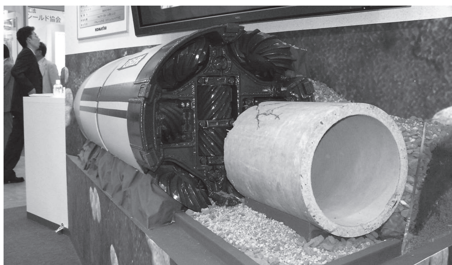
写真ー１ 回転式破碎方式先導体 （下水道展'04横浜コマツ・アイアンモール協会・RPS工法協会ブースより）
