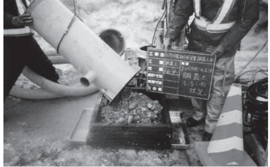
写真-1 土砂/水分離器・ふるい器具
