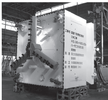
写真－9 ハーモニカ掘進機
