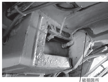
写真－1 岩塊による掘進機の破損
