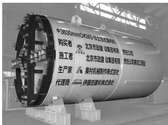
写真-1 北京の電力管路用トンネル掘進用として 外径3.63mの泥土圧シールド機
