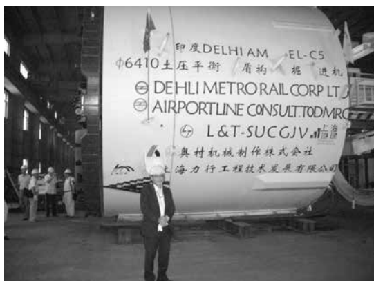
写真-2 インドのニューデリー空港地下鉄線用 外径6.41mの泥土圧シールド機
