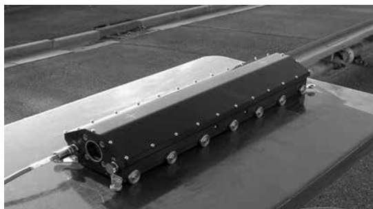
写真-1 レーザ中継器
