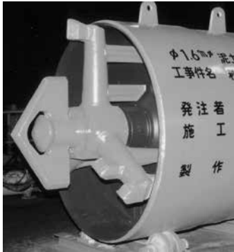
写真-1 φ1600mm泥土加圧掘進機
