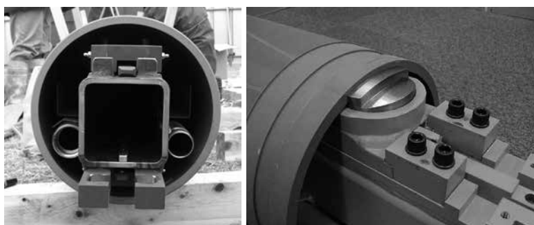
写真-1 インナーユニットと推進管支持装置
