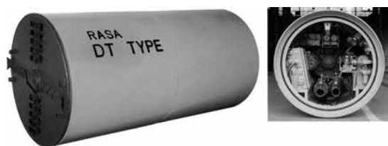
写真-1 1号機DT型掘進機
