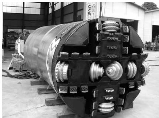
写真-1 マッドマックス掘進機
