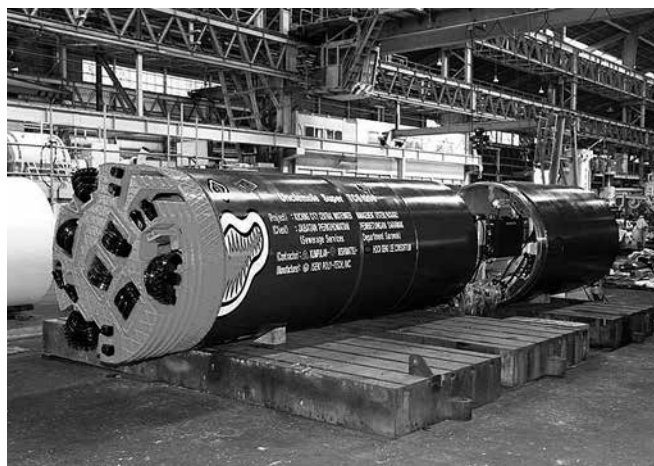
写真-1 φ1200岩盤掘進機
