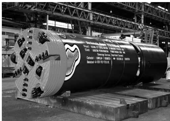
写真-2 φ1500岩盤掘進機
