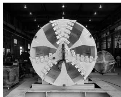
写真十 φ1500泥土圧式掘進機 타이向け工場出荷前
