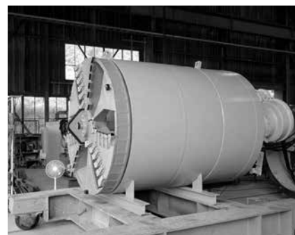
写真九 φ1500泥土圧式掘進機 타이向け工場出荷前
