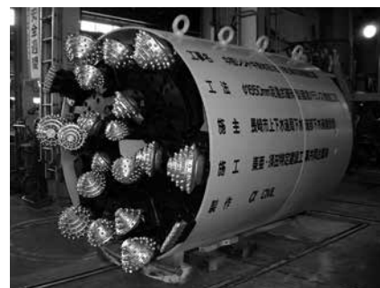
写真-2 リターン回収掘進機：巨石・岩盤対応型（ビット単体型）
