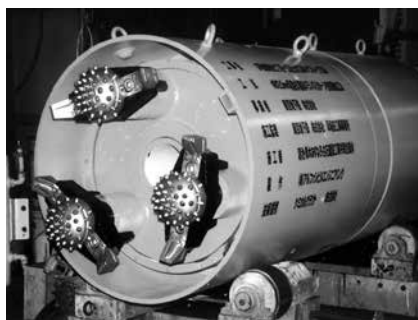
写真-1 リターン回収型掘進機：玉石対応型（多軸自転・公転型）
