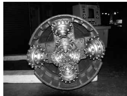
写真-4 掘進機面盤
