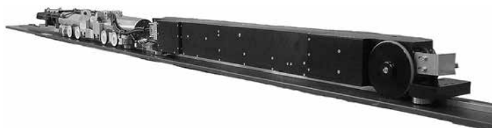
写真－2 ミクロ工法NA型 自走式計測ロボット
