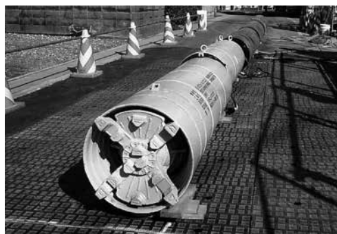
写真-3 30R型先導体 (掘進機・ポンプ筒・強制型曲線誘導機)
