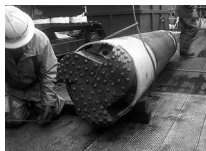
写真-1 ダウンザホールハンマとS型ビット
