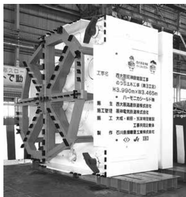
写真－2 ハーモニカ掘進機械
