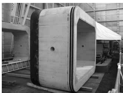
写真－4 ボックスカルパート函体
