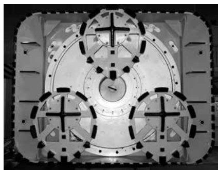
写真－1 密閉型ボックス掘進機前面
