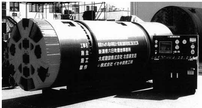
写真一 崩壊性地山に適用された掘進機
