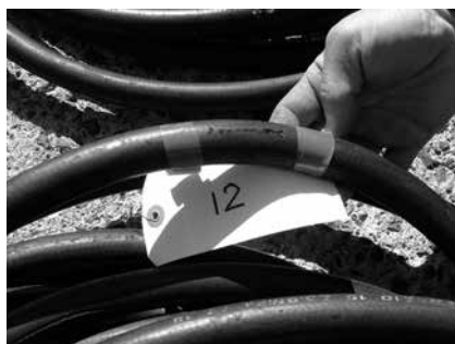
写真-2 油圧ホースの裂傷
