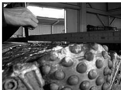
写真-1 オーバービット量の測定状況
