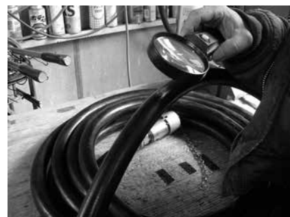
写真-3 油圧ホースの点検
