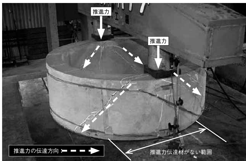
写真-1 載荷位置に推進力伝達材がない場合の実験
