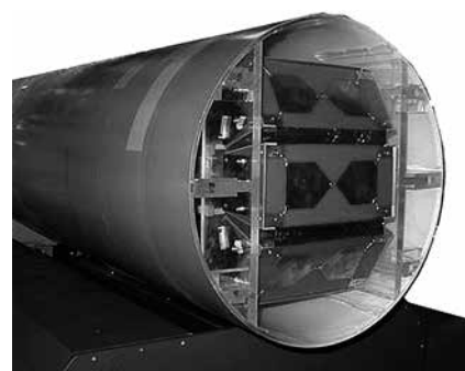
写真-1 電磁波法アンテナ取り付け状況
