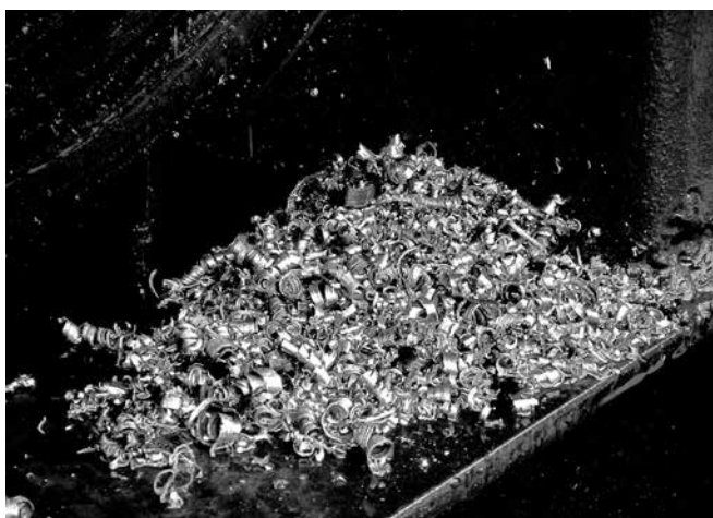
写真-1 特殊ビットで切削した状況
