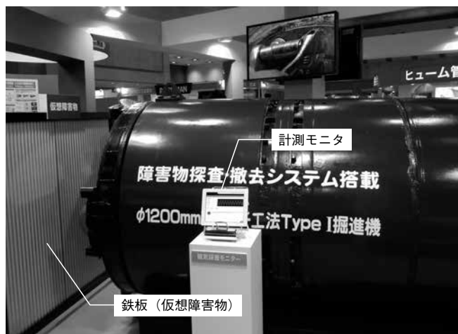
写真-2 障害物探査計測のデモ状況（下水道展にて）
