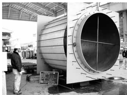
写真-2 内挿管方式内圧強度試験
