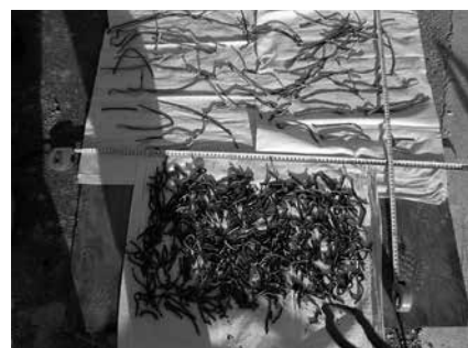
写真-5 鉄筋切断状況
