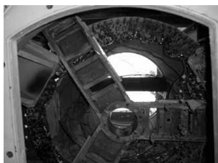
写真-2 地上実験で機内より切羽継輪破碎状況
