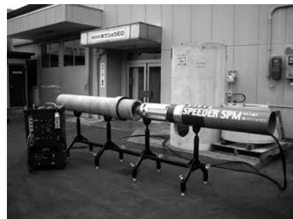
写真-1 破碎機および油圧ユニット
