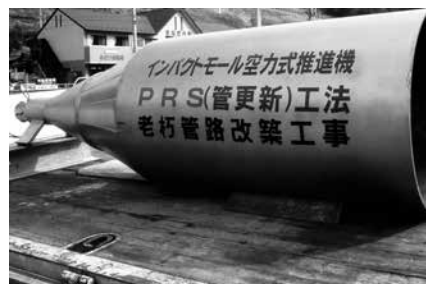
写真ー1 クラッキングヘッド この中にインパクトモール推進機を取り込む
