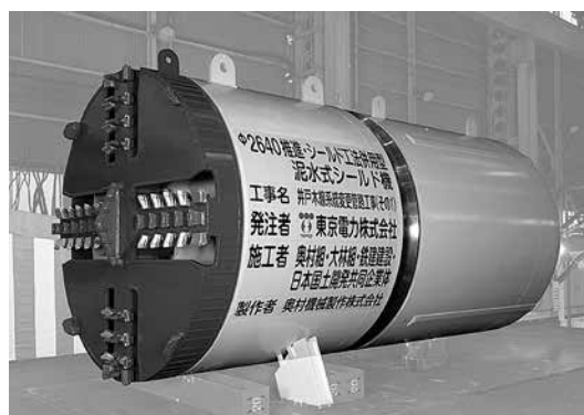
写真－2 ハイブリッド掘進機（全景）
