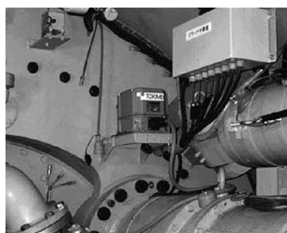
写真－2 ジャイロ装置（出典：機動建設工業HP）
