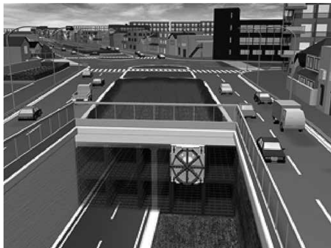
図ー2 大断面分割シールド工法
