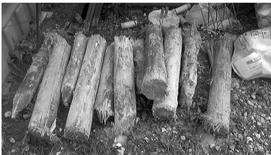
写真-4 推進中切削した松杭
