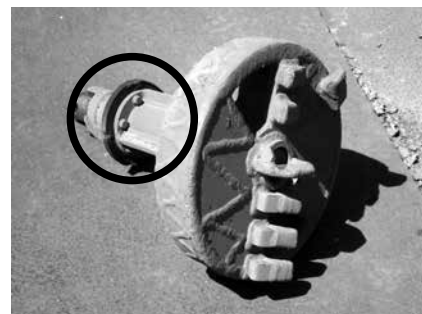
写真-2 帯水型ヘッド ( 20\text{kN/m}^2 )
