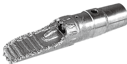
写真-3 注水機構付パイロットヘッド
