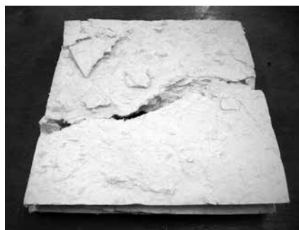
写真-1 逸泥防止材（アトムブロック）納入状態
