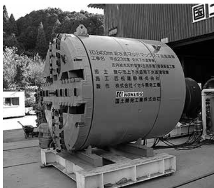
写真-1 泥水式マッドマックス掘進機
