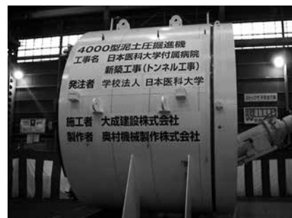
写真-2 泥土圧推進機（側面）
