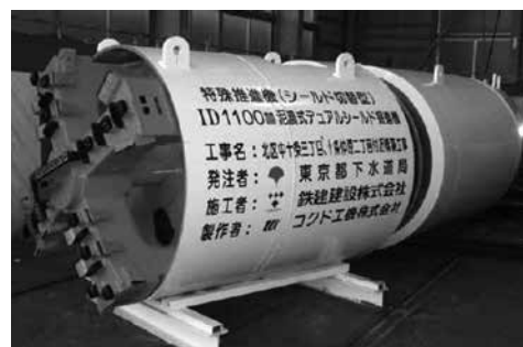
写真－1 使用したφ1,100mm用掘進機
