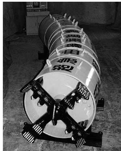
写真-4 超急曲線対応掘進機
