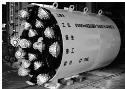
写真-3 破碎型掘進機
