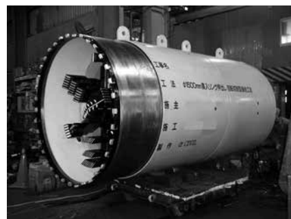
写真-6 貫入リング(回転切削型)対応掘進機
