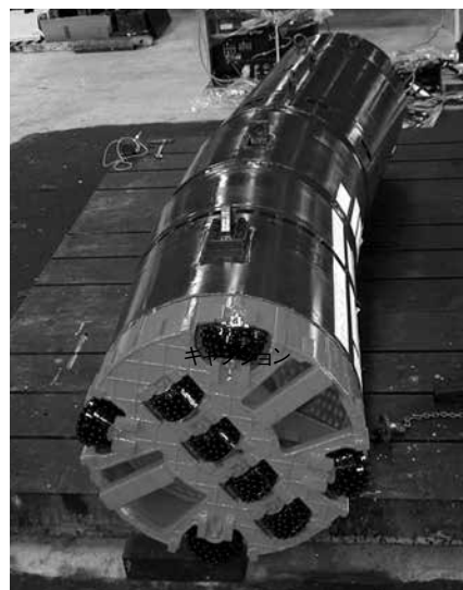
写真-3 掘進機の外観検査の状況
