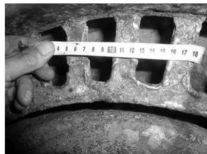
写真-2 クラッシャ開口部の寸法計測の状況
