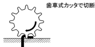
図-2 鉄筋切断のメカニズム
