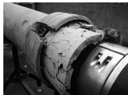
写真-2 破碎実験状況
