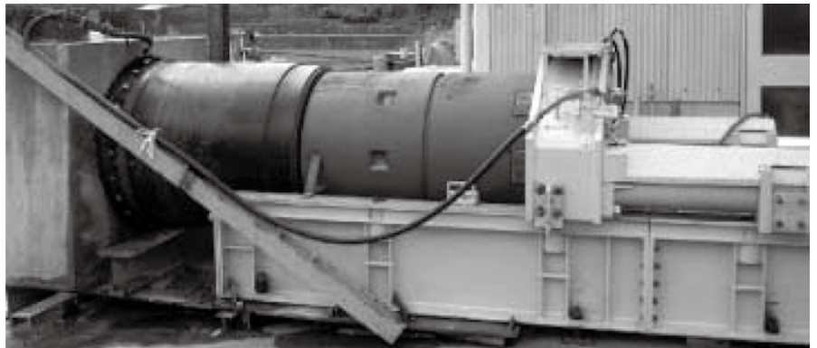
写真-2 コアカッタ試験全景
