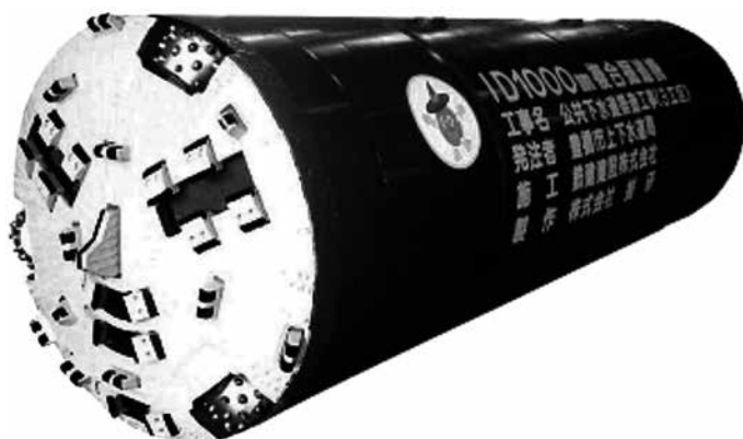
写真-1 超長距離掘進機（世界最長記録1447m）
