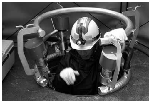
写真－1 従来のファン式送風機（左）とホールエアストリーマ（HAST）（右）
