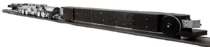
写真-2 自走式計測ロボット (ミクロ工法 NA型)
