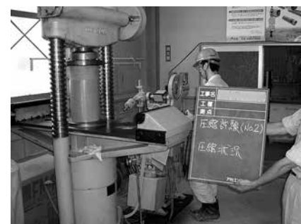
写真-2 塩ビ管圧縮試験
