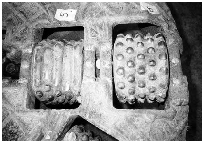
写真-1 磨耗したローラカッタ、取付け軸の折損が原因
