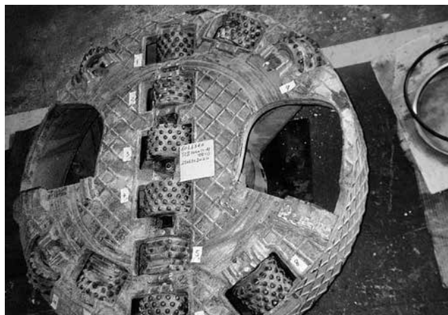
写真-2 磨耗したローラカッタとカッタヘッド
